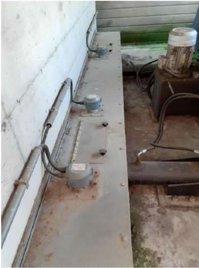
Figura 3 sistema di movimentazione con centrale oleodinamica e sensori
