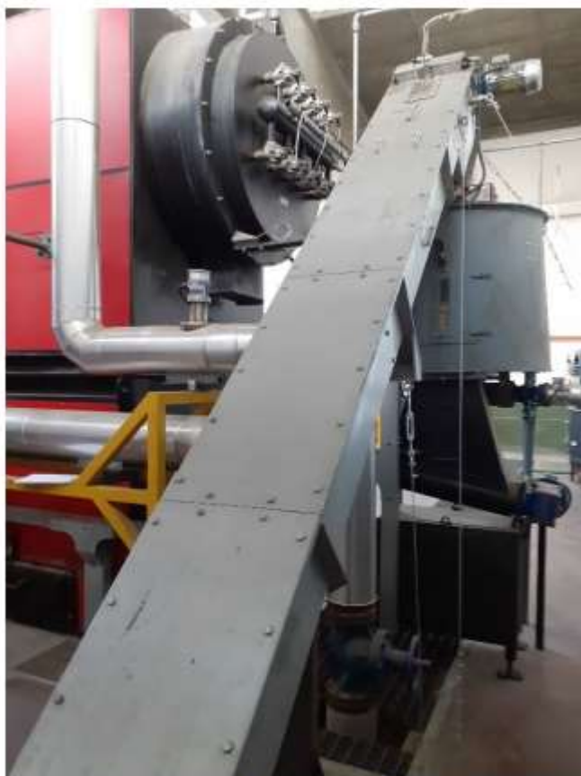
Figura 6 coclea inclinata di trasporto al serbatoio giornaliero
