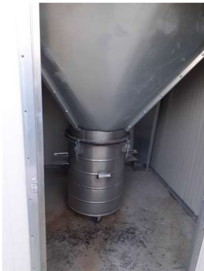
Figura 15 raccolta cenere filtro a maniche con bidone
