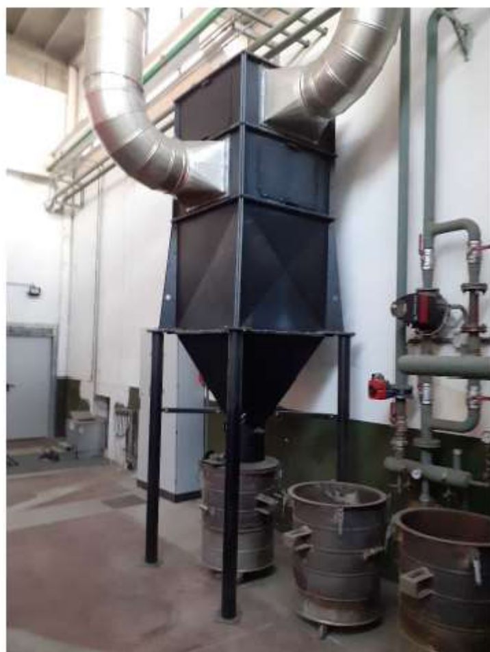
Figura 11 filtro a ciclone
